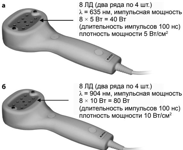
Рис. 4. Матричные лазерные излучающие головки МЛ-635-40 (а) и МЛ-904-80 (б)
