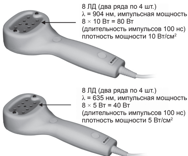
Рис. 3. Внешний вид и параметры матричных импульсных лазерных излучающих головок МЛ-635-40 и МЛ-904-80
